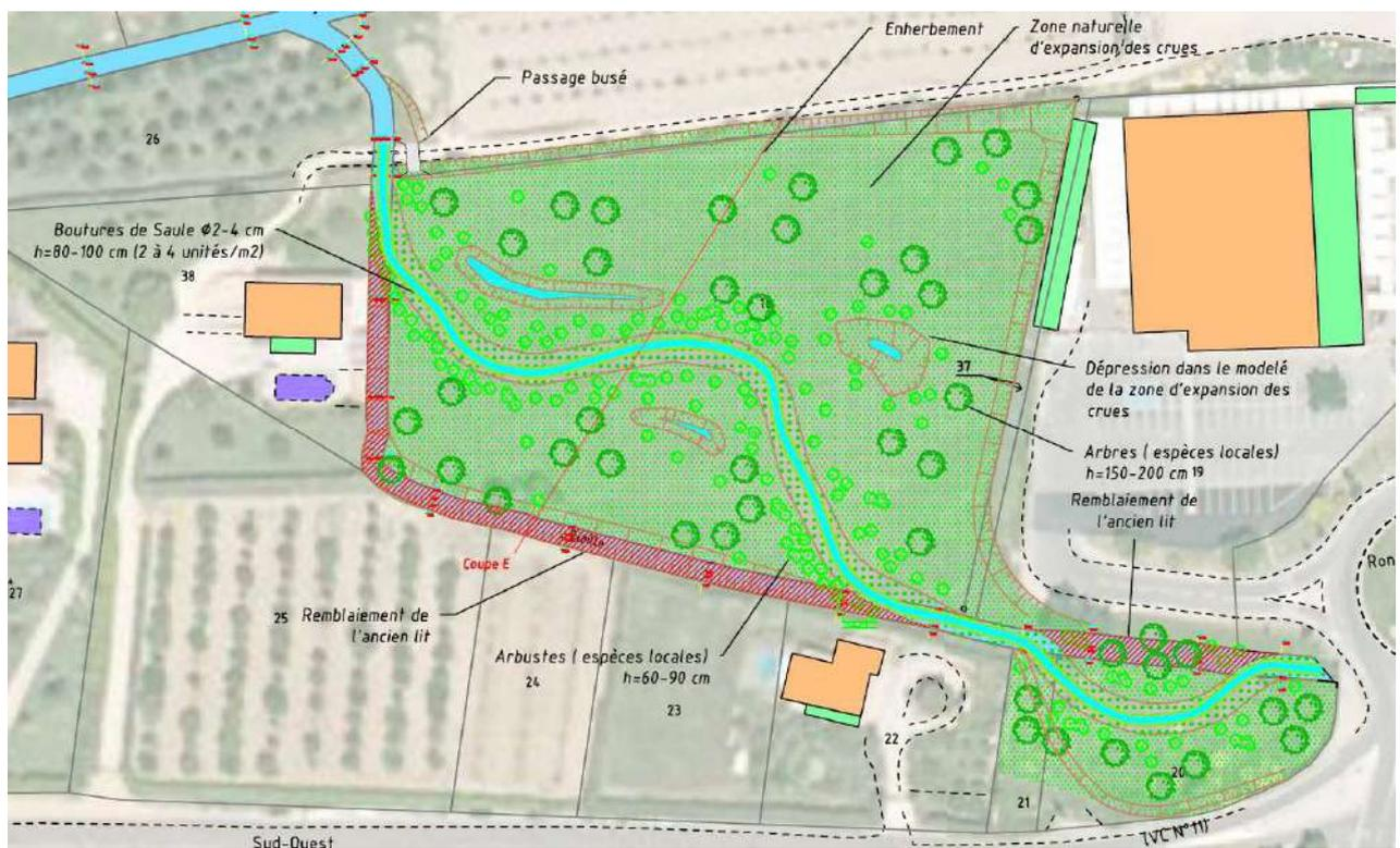
Figure 7 : Extrait de la vue en plan des aménagements sur le tronçon situé en aval de la route d'Orange
